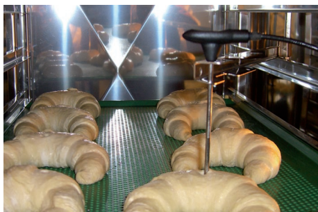
Croissanty mocno wyrastają, dlatego ustawić czujnik temperatury rdzenia pionowo i użyć przyrządu do jego pozycjonowania
